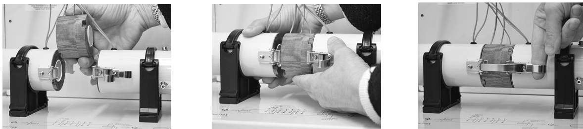
Rys. 4 Montaż elementu środkowego z mosiężnym rdzeniem
