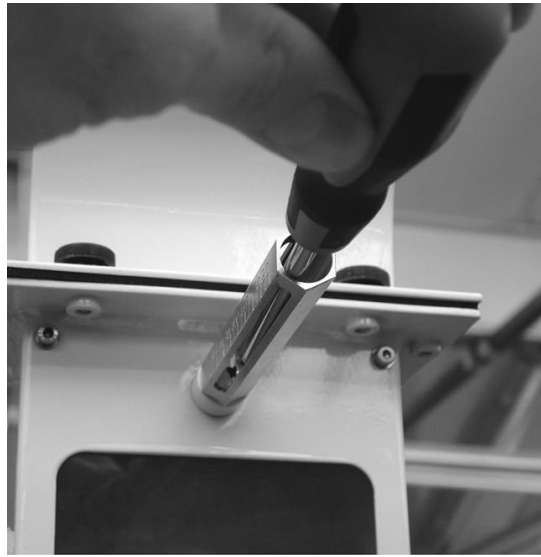
Rys. 12. Mocowanie ruchomej sondy pomiarowej z pomocą śrubokrętu
