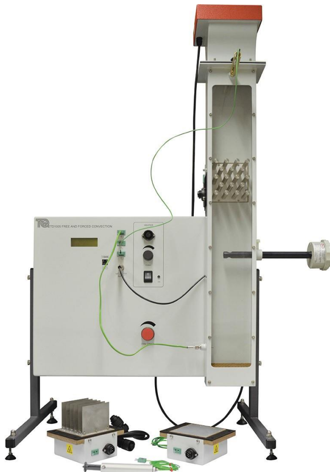
Rys. 1. Stanowisko do badania konwekcji swobodnej i wymuszonej (TD1005)
