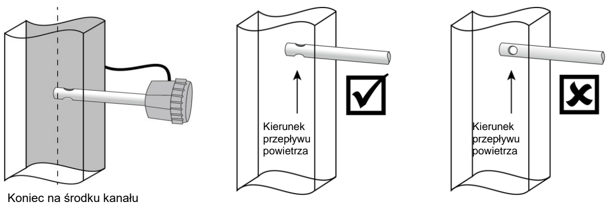
Rys. 11. Montaż anemometru
